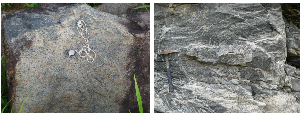
Figura 09: À esquerda, afloramento de migmatito oftálmico, onde predominam estruturas do tipo ocelares. À direita foto de um afloramento de migmatito bandado, com estrutura dobrada onde se pode observar o leucossoma (neossoma) de cor esbranquiçada e o paleossoma/mesossoma de cor preta entre as bandas de cor branca.
