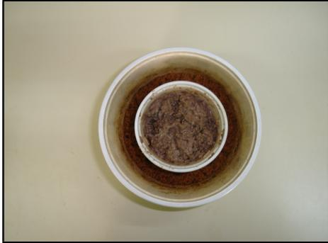
Figura 4 – Frasco com serragem úmida, contendo o recipiente com o confronto.
