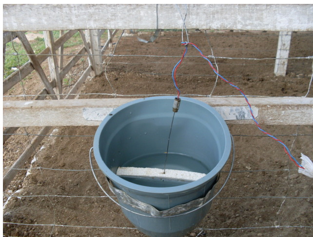
Figura 5. Sensor utilizado para medir a temperatura da água.
