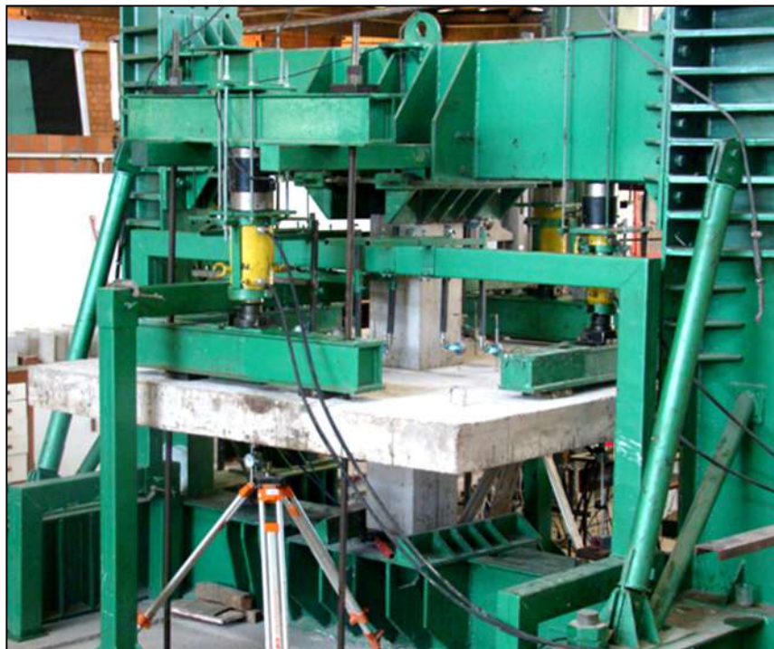
Figura 3.23 – Foto do sistema de ensaio da laje LS01
