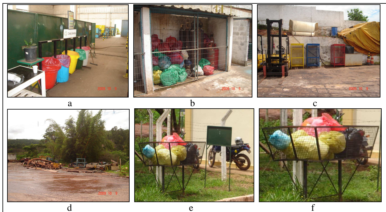
FIGURA 5.1 – Segregação e acondicionamento dos resíduos sólidos gerados na indústria G
