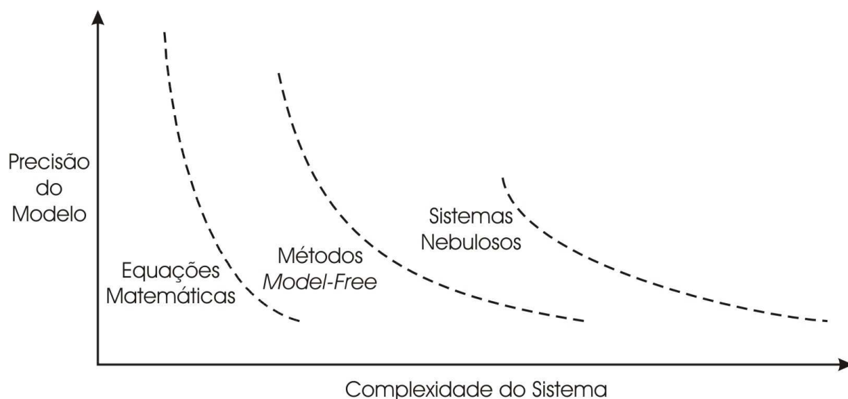
Figura 10: Regiões de atuação de modelos: Complexidade do Sistema Versus Precisão do Modelo.
