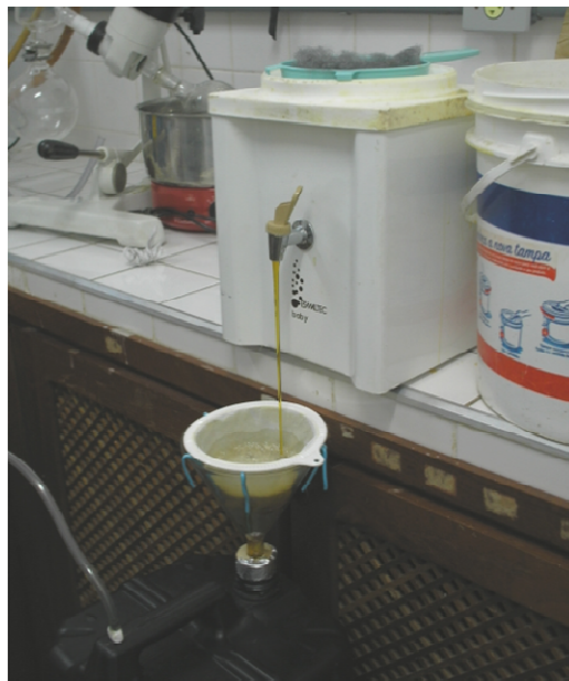
Figura 3.3- Sistema de filtragem a vácuo de OGR.
