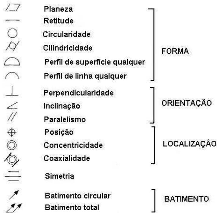
**Figura C.3:** Símbolos da representação geométrica de tolerâncias. Fonte: NBR 6049:1997<sup>[16]</sup>
