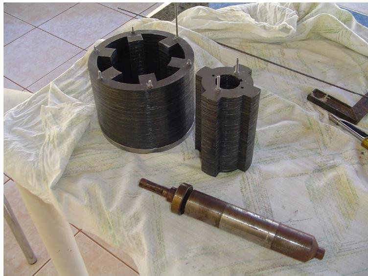
**Figura A3 – Pilhas de Aço Silício (Estator e Rotor).**
