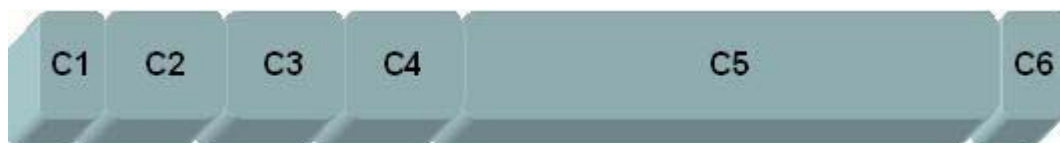
Figura 3.3: Representação do pacote de dados que constitui o protocolo de comunicação entre hardware e software.
