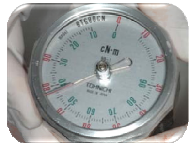
Figura 20- movimento anti-horário aumentando-se o torque-reverso até a rotação do implante no interior do tecido ósseo (N.cm).
