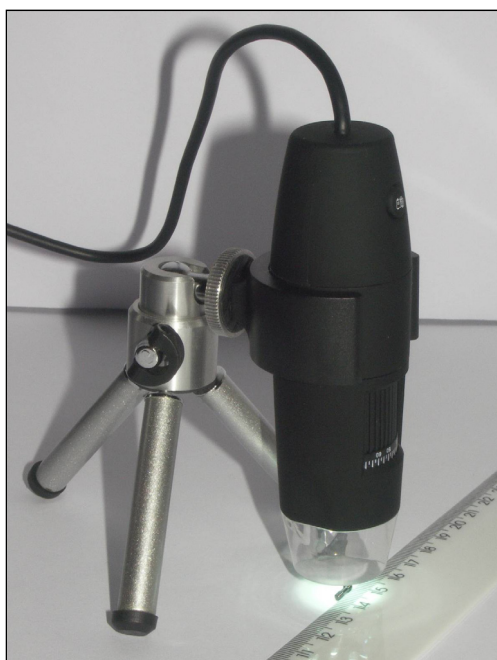
Figura 13: Fotos do microscópio digital analisando um parafuso. A régua foi colocada para fins de referência.
