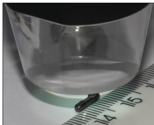
Figura 13: Fotos do microscópio digital analisando um parafuso. A régua foi colocada para fins de referência.
