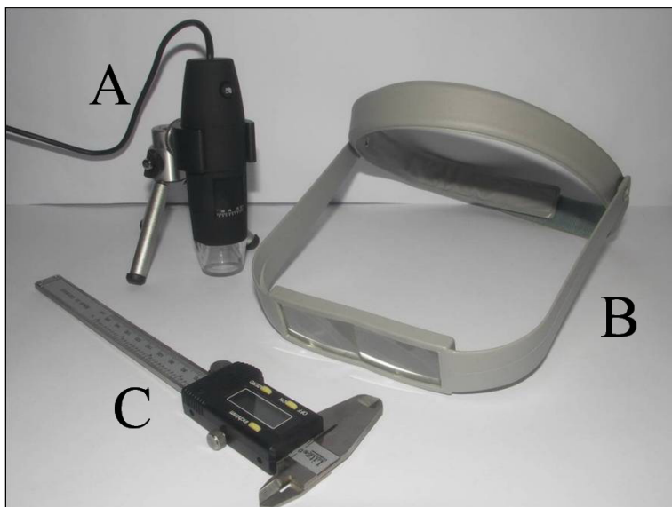
Figura 10: Materiais que foram utilizados para mensuração da geometria dos implantes e componentes protéticos. A = microscópio digital, B = lupa de aumento e C = paquímetro digital
