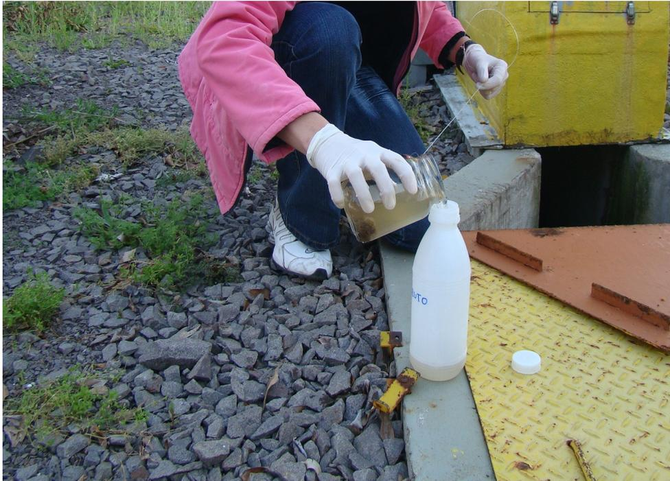
Figura 5. Coleta do efluente bruto, após o gradeamento.
