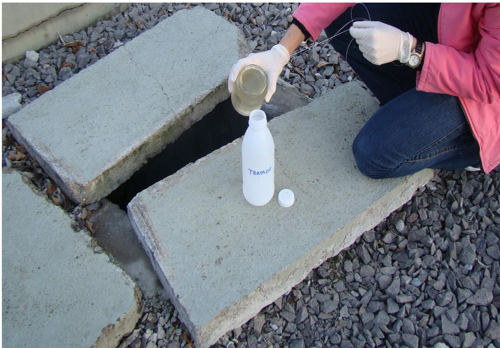
Figura 6. Coleta do efluente tratado, na caixa de inspeção.
