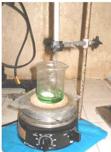
**FIGURA 9:** Representação esquemática da aparelhagem utilizada nas sínteses dos óxidos.
