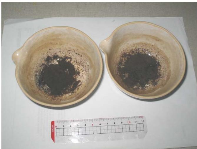
**FIGURA 10:** Material resultante após a calcinação a 400 °C por 2 horas.
