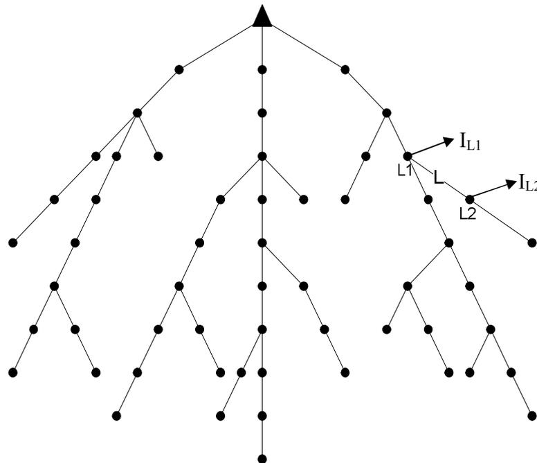
Figura 2.6 – Rede típica de distribuição radial
