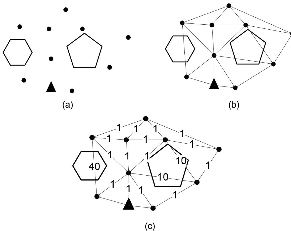
Figura 2.5 – Visualização dos conceitos relacionados a consideração das restrições geográficas: (a) Área para implantação da RDEE, (b) Aplicação da triangulação de Delaunay e (c) Atribuição de pesos
