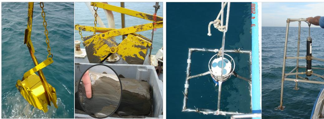
(a) Amostragem de sedimentos com o Van Veen. Fonte: Fábio Nascimento. (b) Detalhe dos equipamentos usados para medir ondas (à esquerda: AWAC; à direita: Vector). Fonte: Fábio Nascimento.
