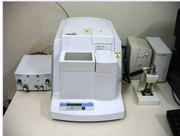
FIGURA 5 – Aparelho de DSC utilizado para identificação das temperaturas de transformação de fase da liga.
