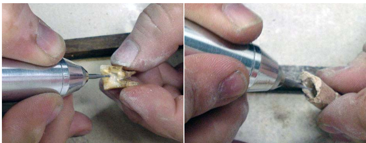
Figura 2.54 – Utilização de broca odontológica para a preparação das amostras (dentes e ossos)
