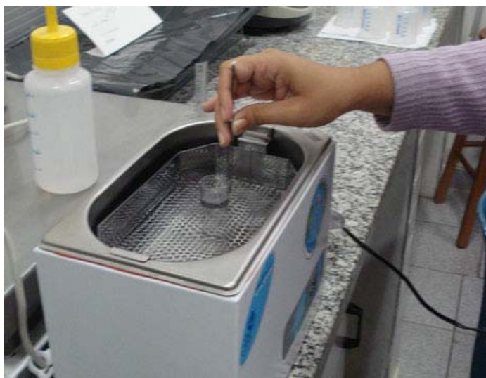
Figura 2.53 – Processo de limpeza através de ultra-som
