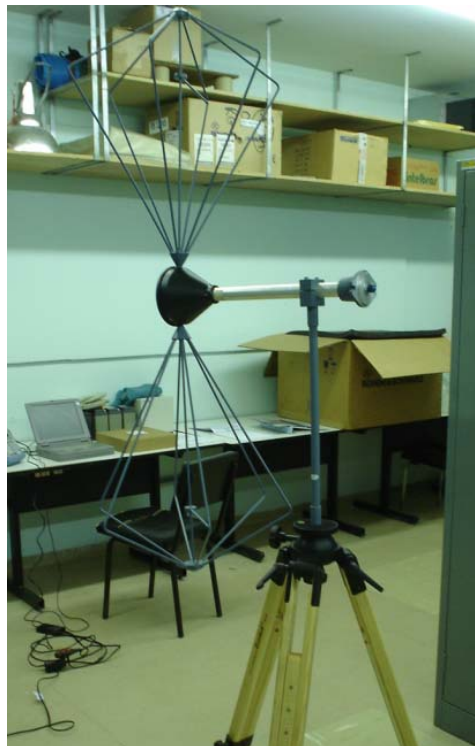
Figura 4.9 - Antena HK116 da R&S
