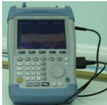
Figura 4.5 – Analisador de Espectro, modelo FSH3 da Rohde & Schwarz
