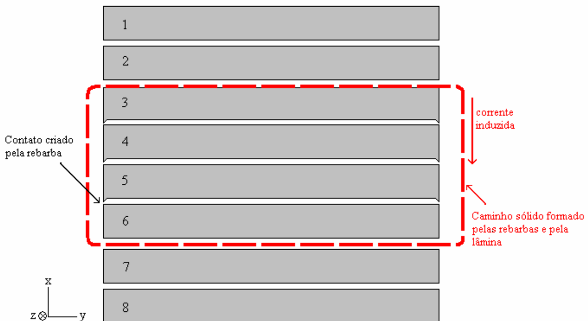
Fig. 5.1 – contato entre lâminas ocasionado pelas rebarbas.
