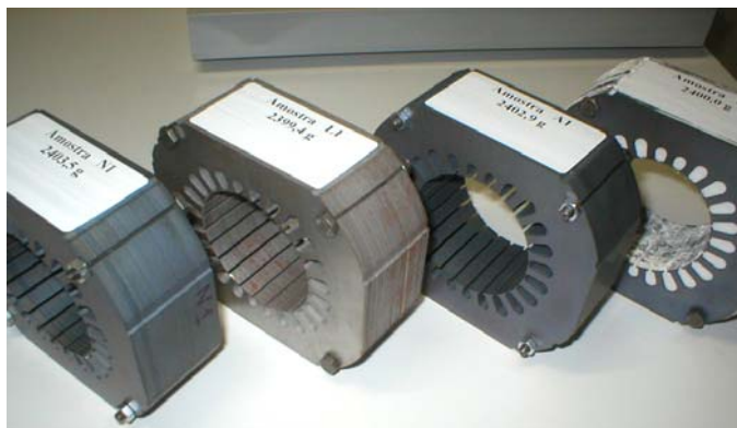
Fig. 3.6 – Os quatro tipos de estatores em função da isolamento entre lâminas
