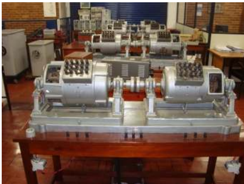
Fig. B-12 – Motor de indução trifásico (direita) e gerador de corrente contínua (esquerda).
