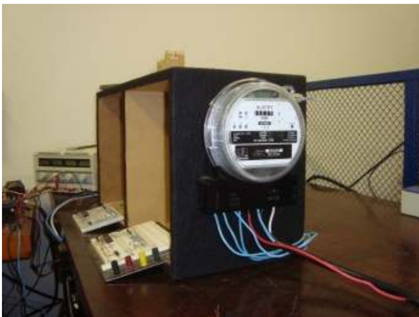
Fig. B-8 – Medidor trifásico do tipo eletrônico.
