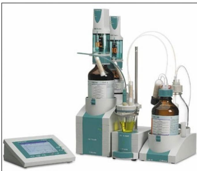
Figura 6 Titulador utilizado para medir o teor de água em amostras
