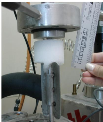
Figura 14 Hidrato formado após 200 minutos no reator de alta pressão
