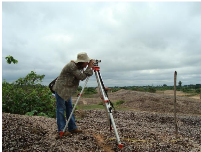
Figura 14: Leitura com nível de precisão para levantamento topográfico.
