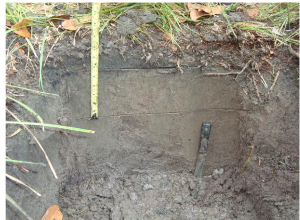
Figura 49: Local da tradagem St1 e perfil do solo da TR4 em Neossolo Quartzarênico Hidromórfico.
