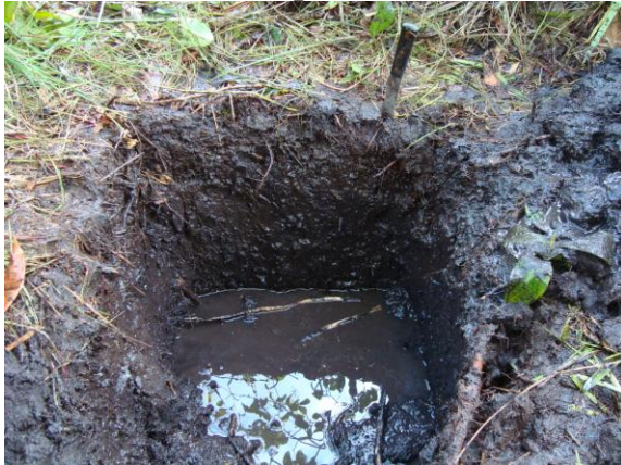
Figura 50: Perfil do solo com o afloramento do nível d'água, com detalhe para a amostra do trado.
