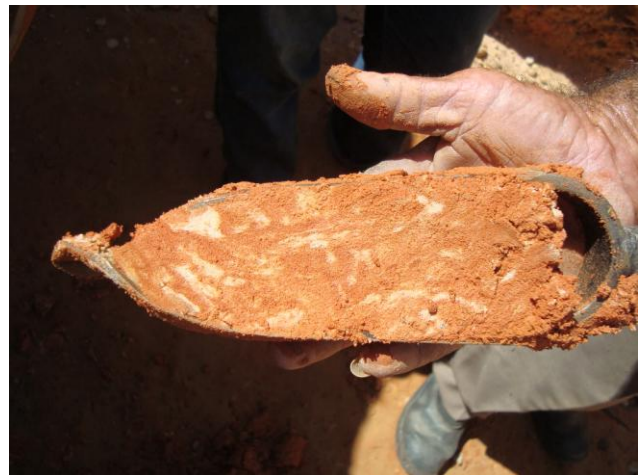
Figura 58: (a) Perfil do material de cobertura proveniente da deposição de rejeito da dragagem sobre cascalho original. (b) Material areno argiloso sob o cascalho original composto por areia muito fina com presença de plintita e gleização, indicando a presença do freático.
