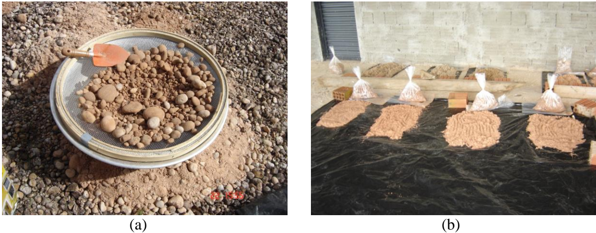
Figura 8: Beneficiamento do material coletado: (a) Peneiramento para separação da fração areia e cascalho (b) Secagem do material para separação granulométrica.
