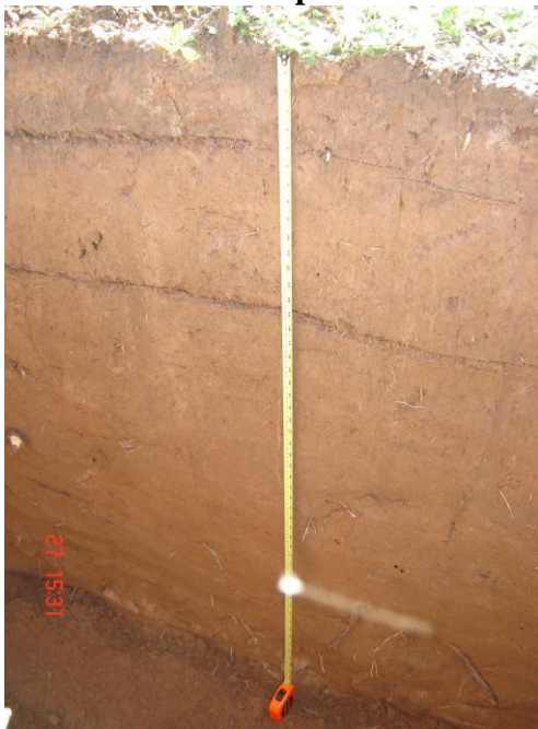
Figura 46: Perfil do solo situado no topo da vertente. Destaque da morfologia do relevo em cobertura de Neossolo Quartzarênico.
