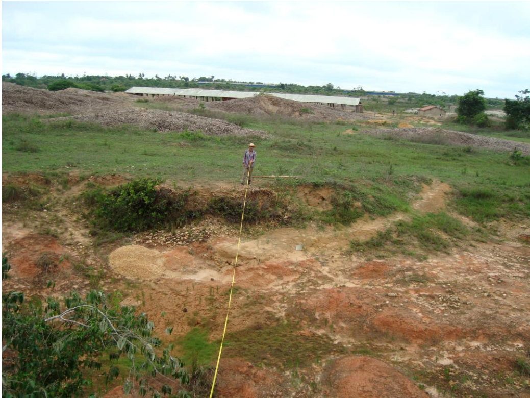
Figura 53: Detalhe da disposição dos rejeitos e morfologia da vertente, onde é nítida a existência de gramínea nos ambientes mais arenosos.
