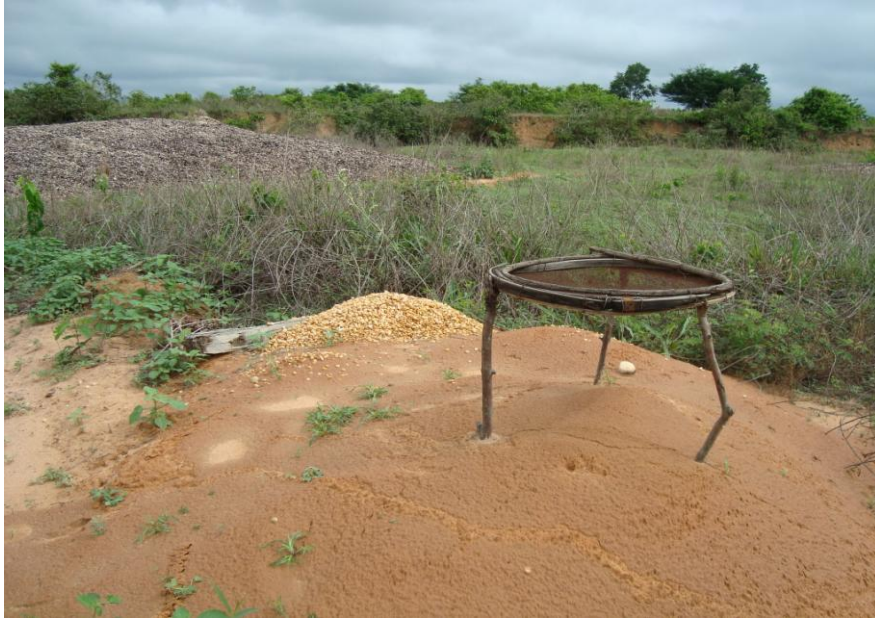
Figura 16: Equipamento denominado “mariquinha” utilizado para separação granulométrica – lavra abandonada.
