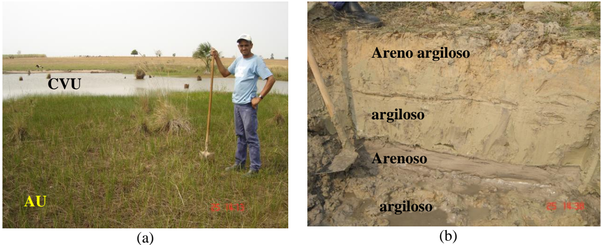
Figura 33: Ambiente de Areia úmida (Au), ao fundo temos a cava, próxima a nascente: (a) Área que recebeu a deposição de material fino proveniente da dragagem. (b) Perfil da trincheira mostrando intercalação da deposição de argila e areia.
