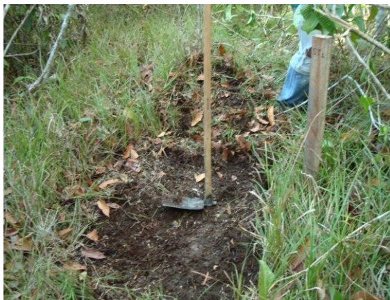
Figura 49: Local da tradagem St1 e perfil do solo da TR4 em Neossolo Quartzarênico Hidromórfico.
