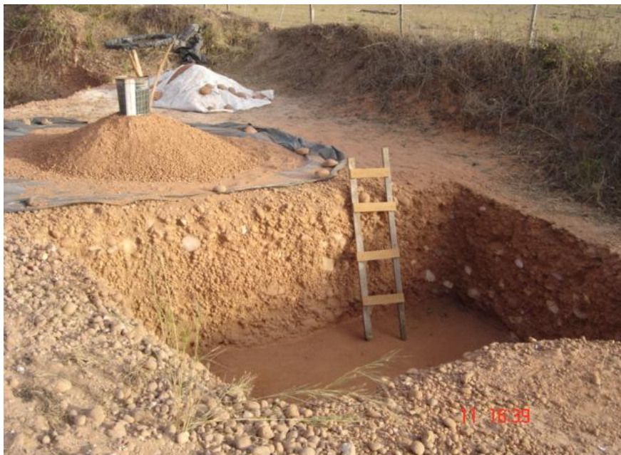
Figura 15: Lavra manual do cascalho diamantífero, detalhe da separação do material mineralizado pronto para a lavagem - lavra recente.
