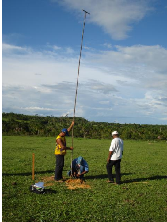
Figura 13: Execução de sondagens a trado para identificação dos solos e posicionamento do freático.
