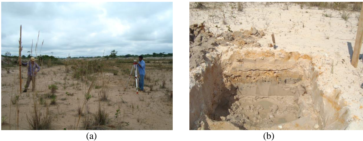
Figura 29: Ambiente de areia. (a) No ambiente de areia a topografia é em geral plana. (b) Abertura de trincheira para caracterização do material.
