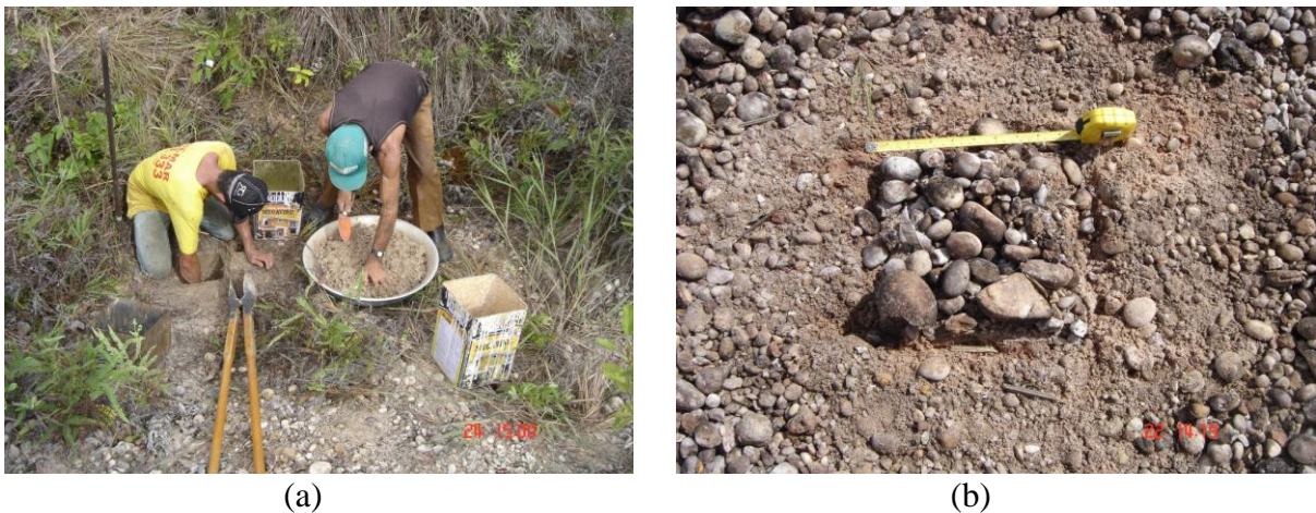
Figura 7: Ambiente degradado por garimpo: (a) Coleta, homogeneização e quarteamento de material em ambiente de areia e cascalho. (b) Coleta de material em ambiente de cascalho.
