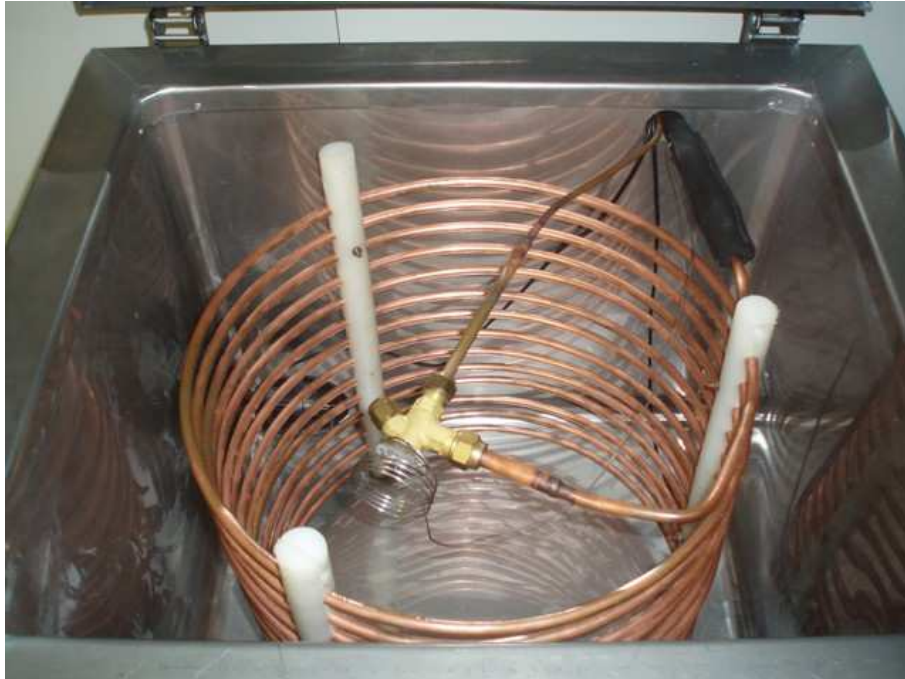
Figura 5. 15 - Válvula de Expansão e Evaporador.
