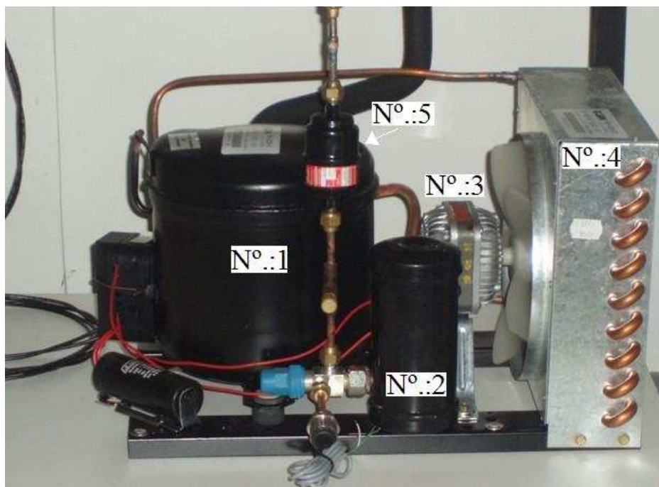
Figura 5. 14 - Unidade de Refrigeração - Itens do Ciclo de Compressão.
