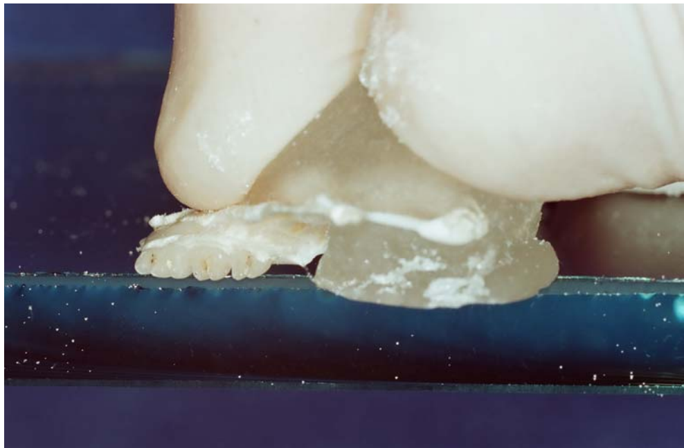
Figura 4 - Amostra da mandíbula fixada em resina acrílica mostrando o apoio para os dedos do operador, a fim de protegê-los durante os procedimentos de desgaste.
