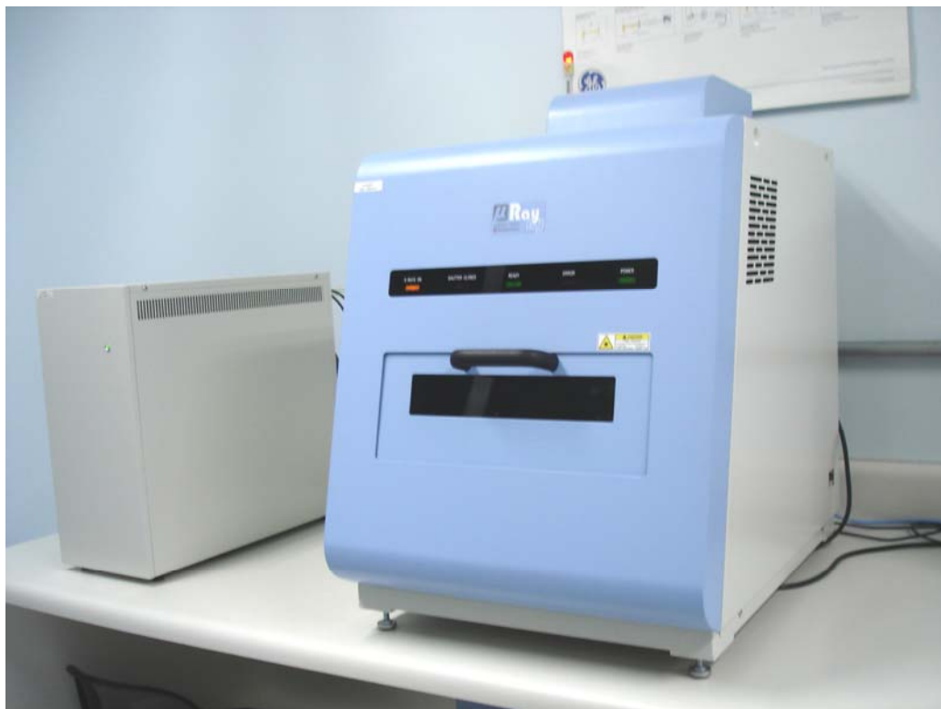
Figura 5 - Espectrômetro de microfluorescência de raios-X por energia dispersiva ( \mu EDX 1300 Shimadzu – 50 \mu ).
