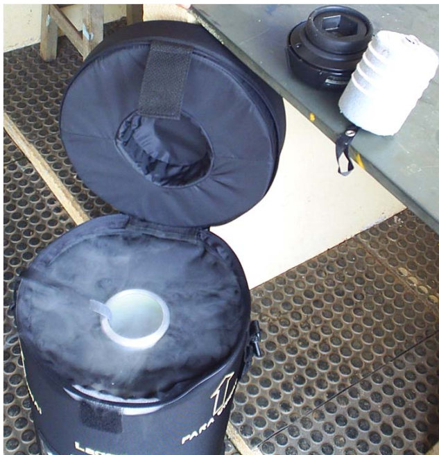
Figura 3 Botijão de vapor de nitrogênio dry-shipper
