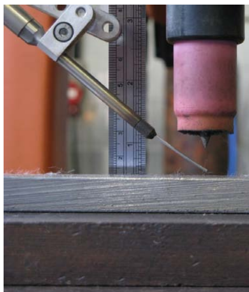
Figura 4. Direcionador do arame para o arco.
