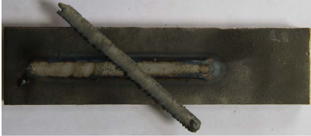
Figura 69. Fotografia do ensaio no qual o cordão de solda não aderiu ao metal base.
