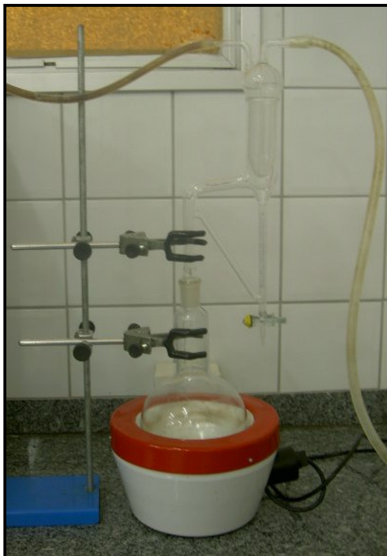
Figura 7. Aparelho de hidrodestilação tipo clevenge (arraste de vapor).
