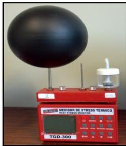
**Figura 13.** Vista parcial do termômetro de globo digital utilizado no Experimento 2.
