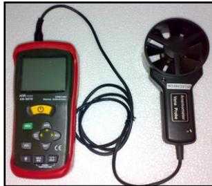
**Figura 9.** Vista parcial do anemômetro digital de hélice.
