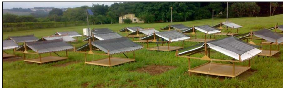
**Figura 12.** Disposição dos modelos reduzidos simulando galpões avícolas utilizados no Experimento 2.
