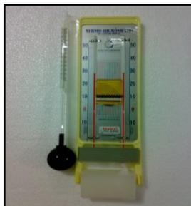
Figura 7. Vista parcial da fixação do globo-termômetro ao termo-higrômetro de leitura direta.
