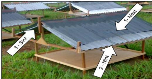
**Figura 17.** Vista parcial das posições de leitura dos dados da temperatura de bulbo seco.
