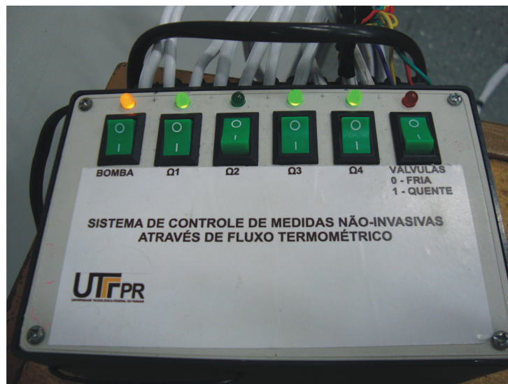
Figura 17: Painel de controle do sistema de medição não-intrusivo de vazão através de termometria.
