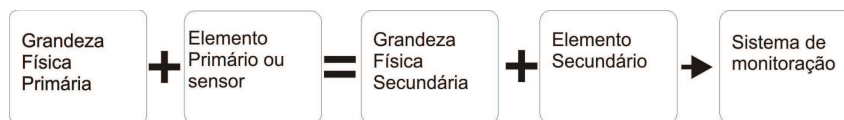
Figura 2: Representação simplificada das etapas necessárias na construção de um sistema de medição geral.
