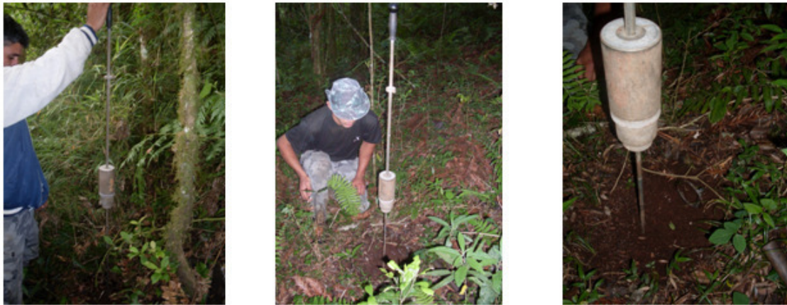
Figura 08. Medida da resistência à penetração do solo
