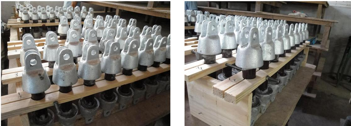
**Figura 15. Fotografias mostrando corpos-de-prova para ensaio de tração dispostos em suporte de alinhamento em processo de cura do cimento.**
