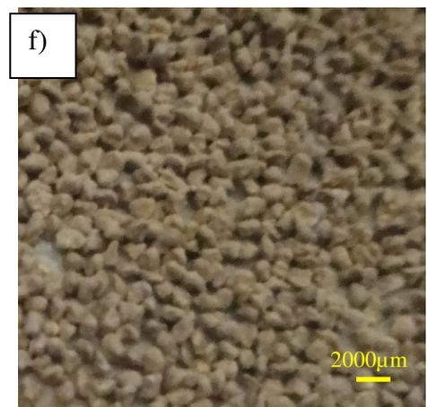
Figura17(f) Fotografia de placa cerâmica com aplicação de granilha 2 em substrato não esmaltado, após processo de queima.
