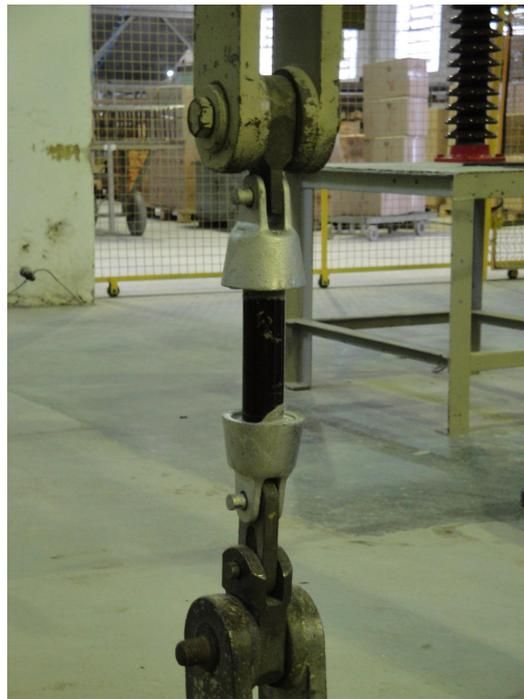
**Figura 16. Fotografia mostrando o conjunto corpo-de-prova e ferragem cimentada submetido a ensaio de tração.**
