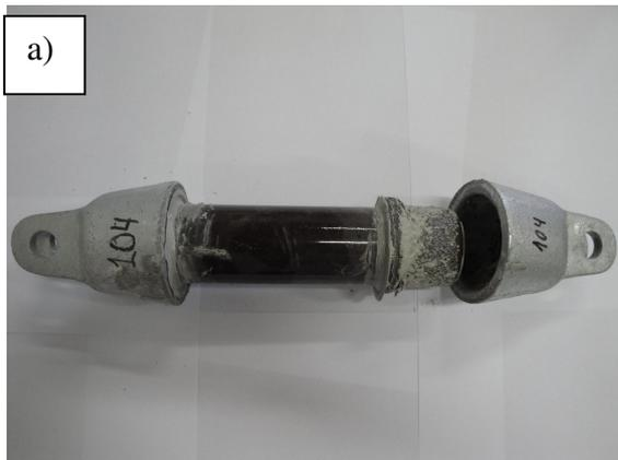
**Figura 18(a)** Fotografia de corpo-de-prova submetido a ensaio de tração contendo granilha 3 com substrato esmaltado.
