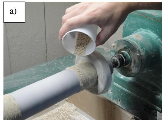
**Figura 11(a) Fotografia evidenciando a aplicação de cola para granilha padrão em corpo-de-prova.** **Figura 11(b). Fotografia evidenciando a aplicação de granilha em corpos-de-prova.**
