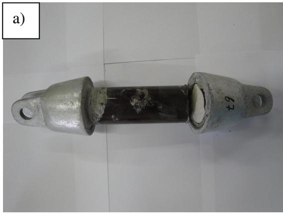
**Figura 16(a)** Fotografia de corpo-de-prova submetido a ensaio de tração contendo granilha P com substrato esmaltado.
