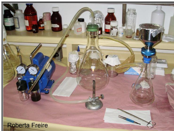
Figura 8. Sistema de filtração
