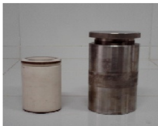
Figura 18 – À direita autoclave de aço inoxidável e a esquerda cadinho de teflon
