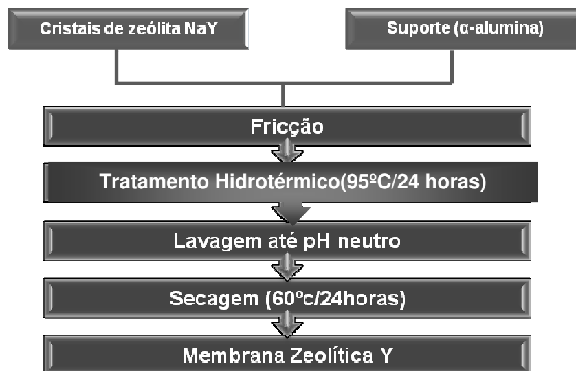
Figura 23 – Fluxograma de preparação da membrana zeolítica (zeólita Y/ \alpha -alumina).
