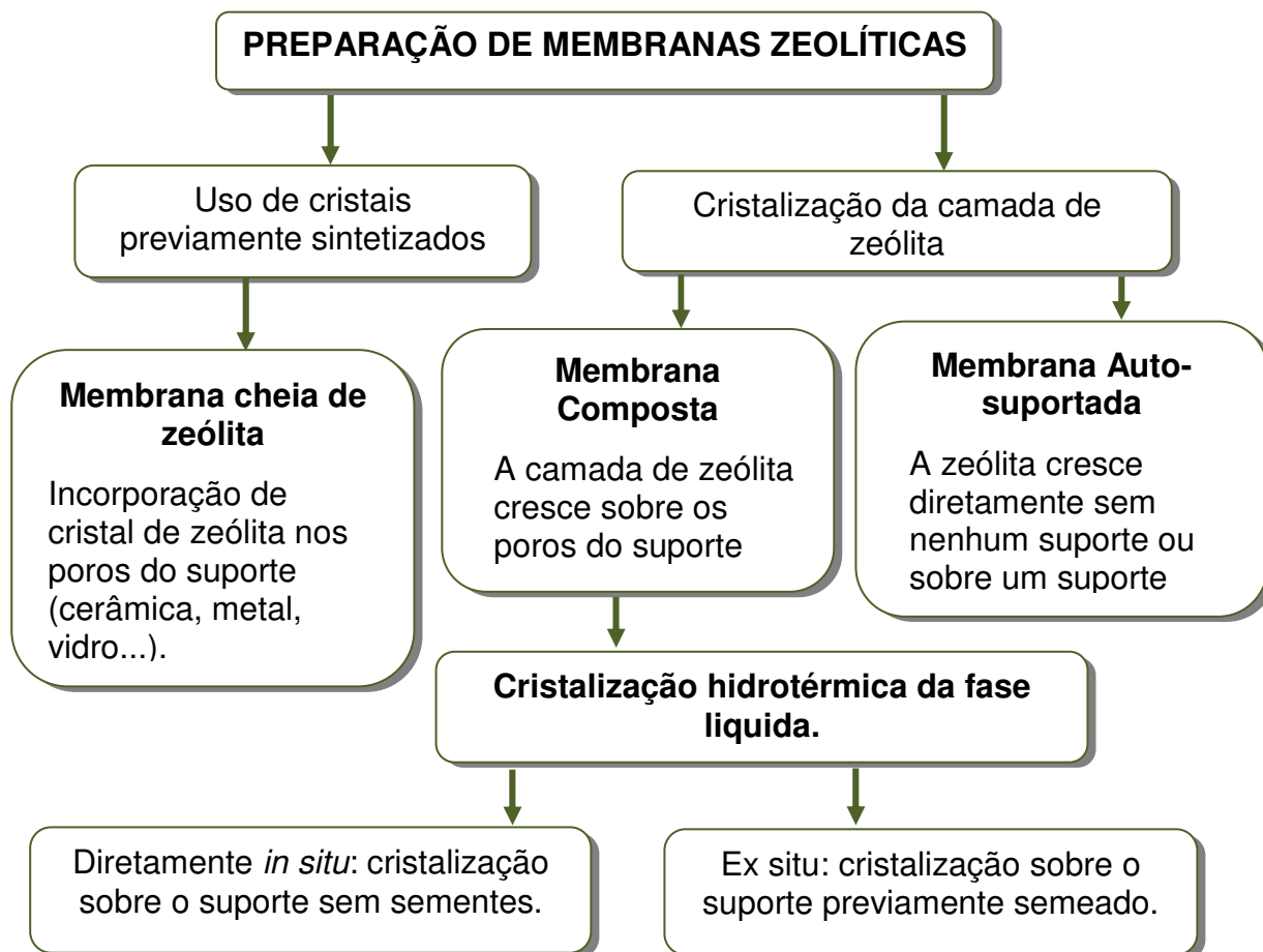
Figura 14 – Estratégias de síntese para preparação de membranas zeolíticas. Fonte: TITUS (2006).
