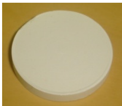
Figura 22 – Suporte cerâmico ( \alpha -alumina) sinterizado a 1200°C.
