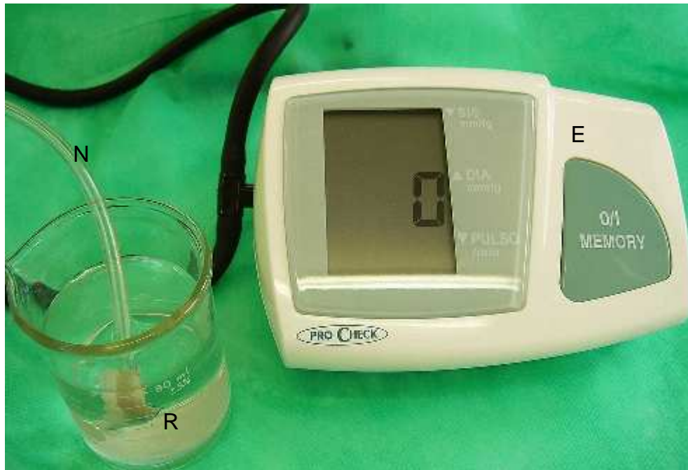
FIGURA 11 - Dispositivo para medida da pressão de ruptura. Esfigmomanômetro digital (E). Cateter de Nelaton (N). Recipiente com água (R).
