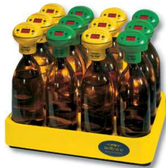
Figura 18 - Frascos com sensores utilizados no teste respirométrico manométrico.
