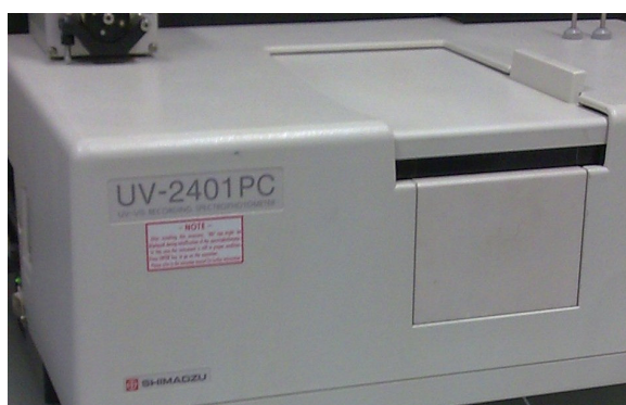
Figura 2.11 - Equipamento de espectrofotometria UV-VIS usado para leitura OSL.
