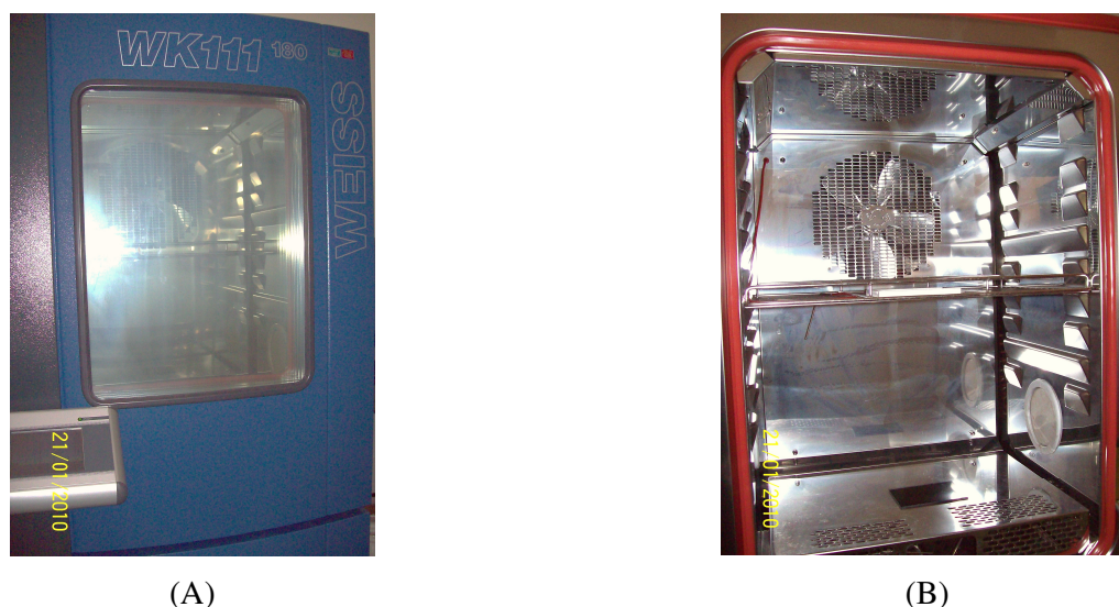
Figura 2.8 – Câmara climática com a amostra no suporte. A) Visão externa. B) Visão interna.
