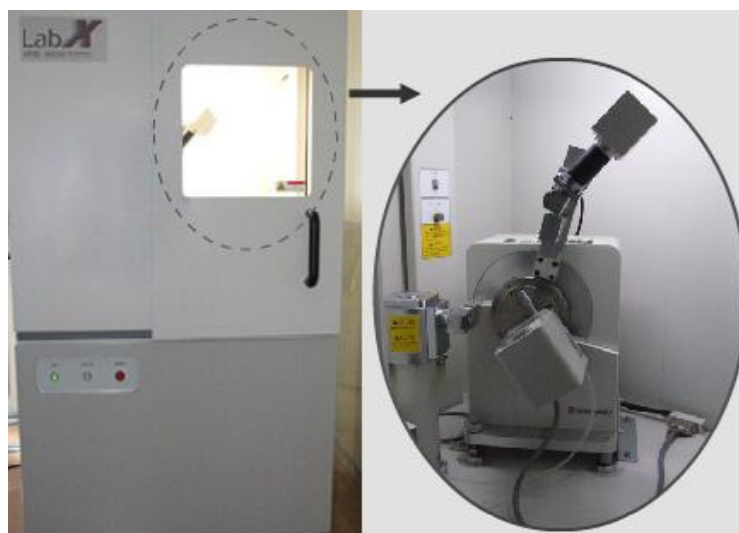
Figura 1.29 – Difratorômetro de raios X. (CETEC-MG, 2009)
