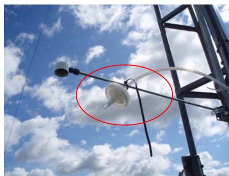
FIGURA 2B Tomada de amostra de \text{CO}_2 do Li-cor
