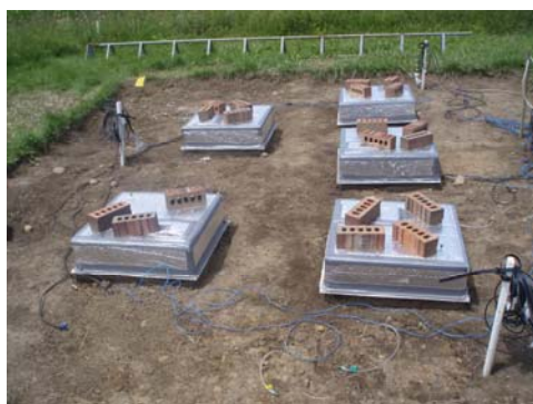
FIGURA 1A Câmaras estáticas instaladas no solo para amostragem de CO 2
