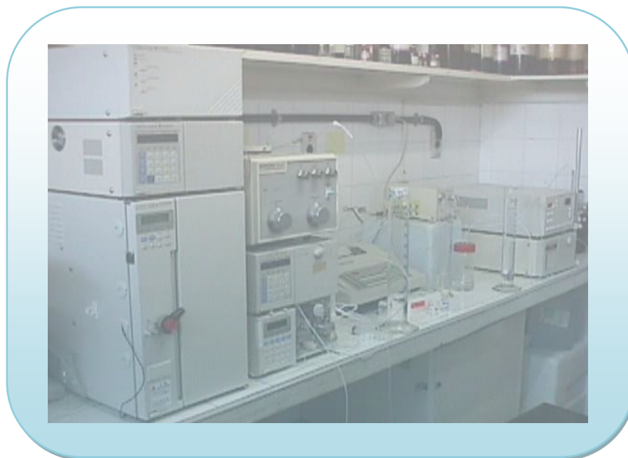
Figura 11: Aparelho de HPLC com detecção de fluorescência e eletroquímica.
