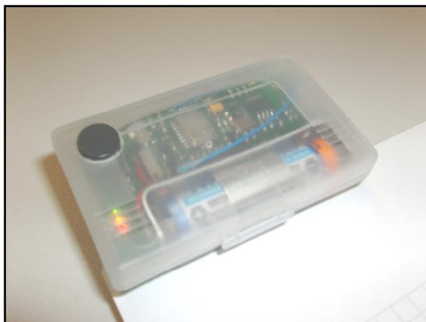
**Figura 43: Protótipo de dispositivo móvel com LEDs acesos.**
