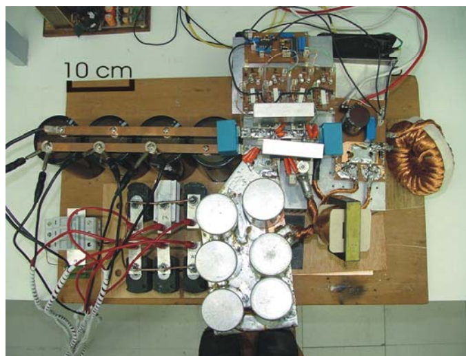
Figura 6.2 – Conversor FB-ZVS-PWM com filtro capacitor na entrada e diodos para conexão dos módulos de CaC.
