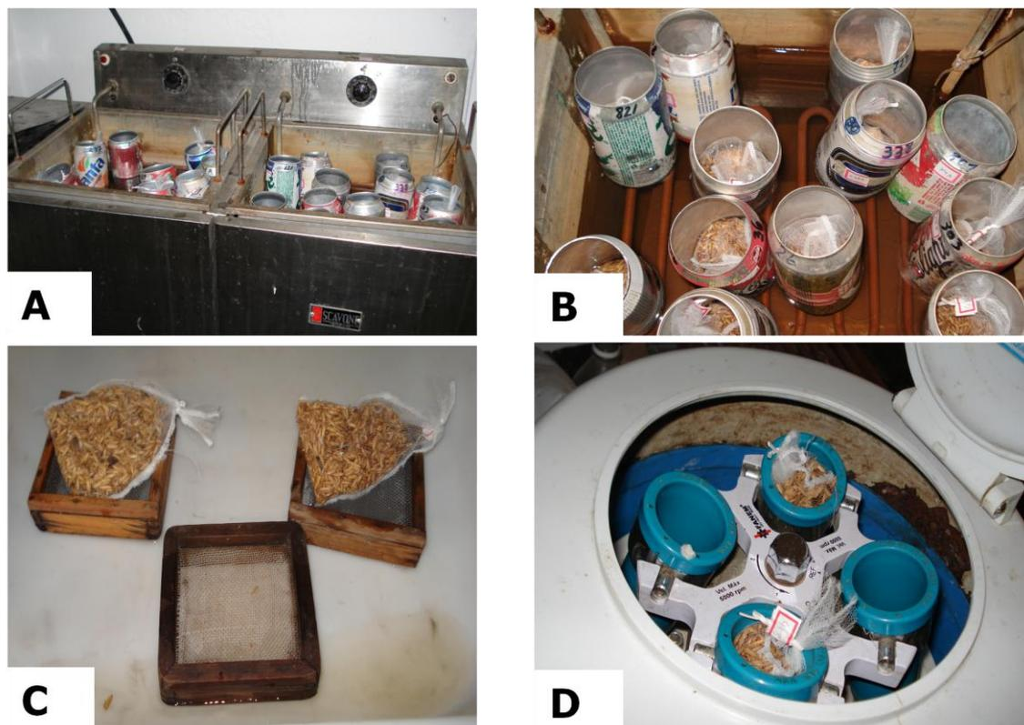
**Figura 7** – Etapas de operação para construção de isotermas de adsorção de água das amostras de arroz: (A) e (B) = amostras de 50 g arroz durante a fase de encharcamento; (C) = remoção do excesso de água sob peneira; (D) centrifugação.
