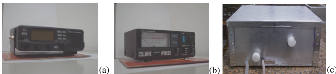
FIGURA 1.1 – (a) Rádio-transmissor modelo ICOM V-8000 ; (b) Wattímetro de Linha modelo Cellwave KW-525 ; (c) Exterior do filtro acoplador de impedância tipo-L em que são mostrados os botões de sintonia fina dos capacitores variáveis e os terminais de saída nos quais se conectam os eletrodos do dispositivo de microdescarga.
