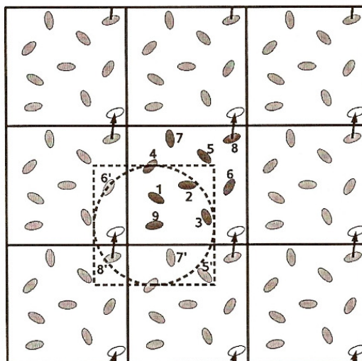
Figura 3.4: Replicação das caixas e condição periódica de contorno, onde o quadrado tracejado representa a convenção de mínima imagem. A representação é bidimensional de um sistema periódico, onde as partículas podem entrar ou sair de cada caixa, atravessando qualquer um dos seus quatro lados [38] .
