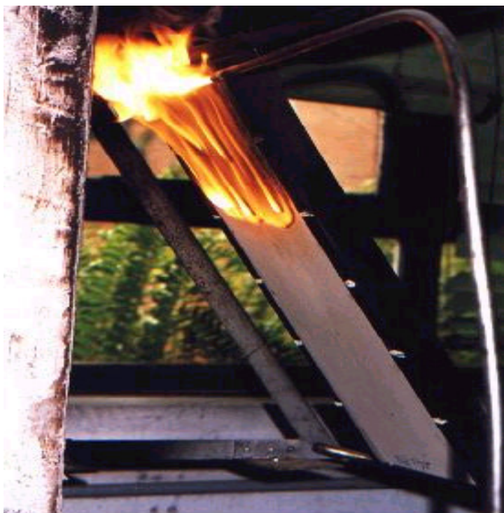
FIGURA 12: ENSAIO DE REAÇÃO AO FOGO
