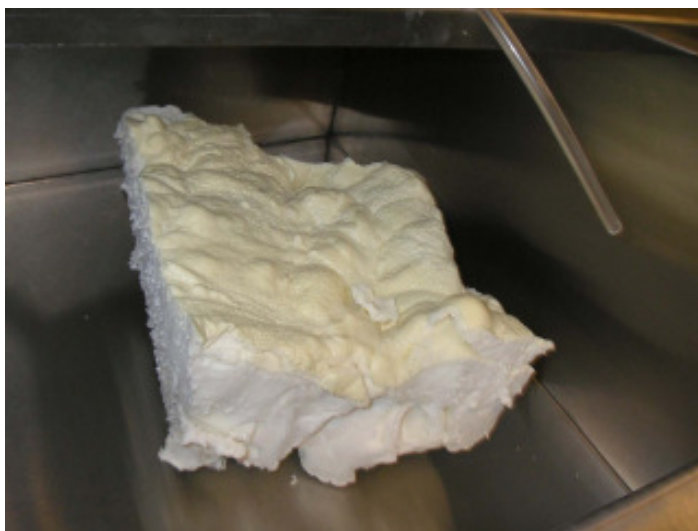
FIGURA 3 : Amostra de poliuretano sendo testada em câmara FONTE: Black (2010) - Greenguard Institute
