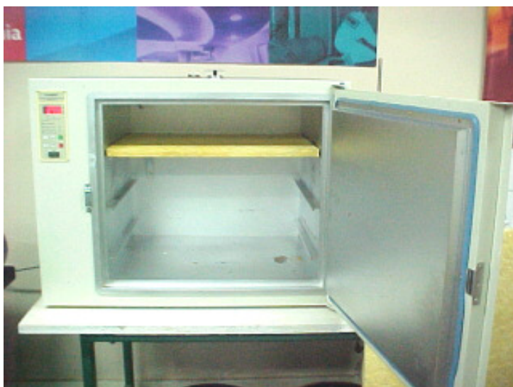
FIGURA 11: ESTUFA PARA ENSAIO DE DESCOLAMENTO
