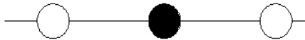
Figura 1.1: Vizinhos próximos (bolas brancas) do spin i (bola preta) em uma cadeia linear.
