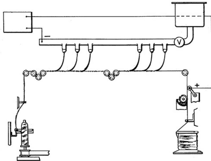
FIGURA 13 – Método de Formhals para produção de fibras artificiais
