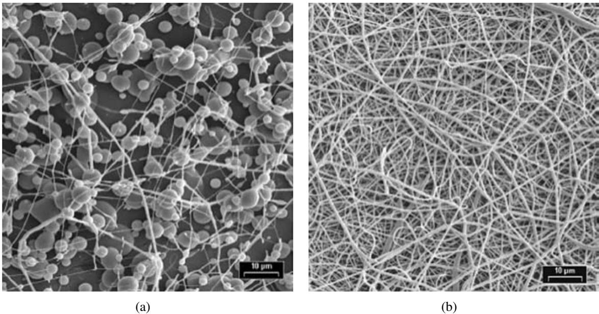
FIGURA 17 – Imagens MEV de nanomembranas de PCL (concentração: 5% em peso, solvente: clorofórmio, distância entre coletor e agulha: 7,5 cm):
