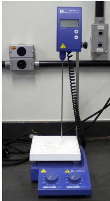
FIGURA 24 – Misturador magnético com placa aquecida IKA<sup>®</sup> CERAMAG Midi
