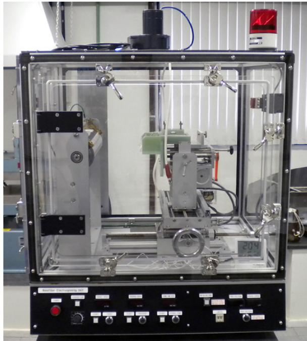
FIGURA 26 – Unidade de *electrospinning* do *Laboratório de Nanocompósitos*
