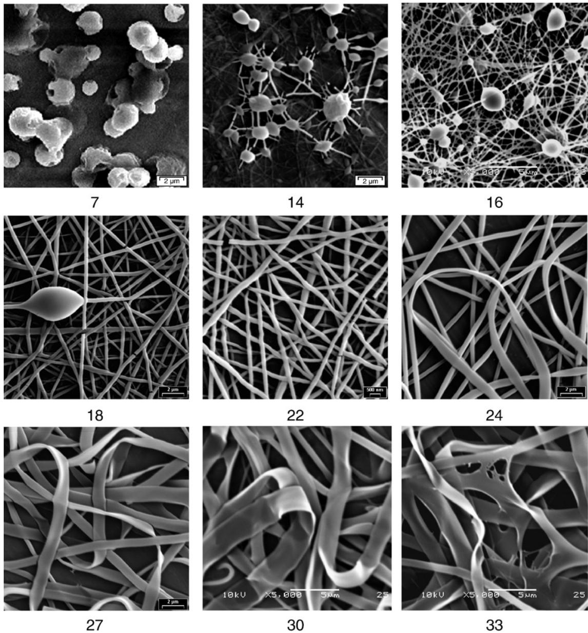
FIGURA 16 – Influência da concentração (% em peso) de PVA na morfologia das fibras geradas por *electrospinning*
