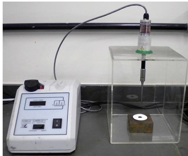
FIGURA 25 – Misturador por ultrassom Misonix Microson<sup>™</sup> XL200
