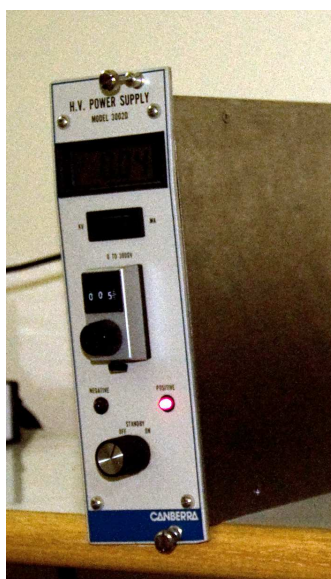
Figura 3.2: Gerador de alta-tensão H.T. Canberra (DEN/UFPE)
