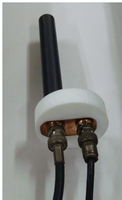
Figura 2.27: Câmara de ionização finalizada conectada aos cabos.
