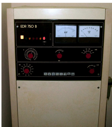
Figura 3.4: Controlador da alta tensão e corrente do aparelho de raio-X (DEN/UFPE)
