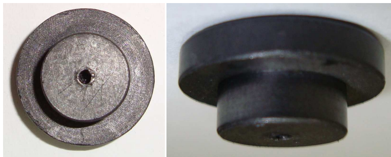
Figura 2.19: Tampa da janela de entrada finalizada.
