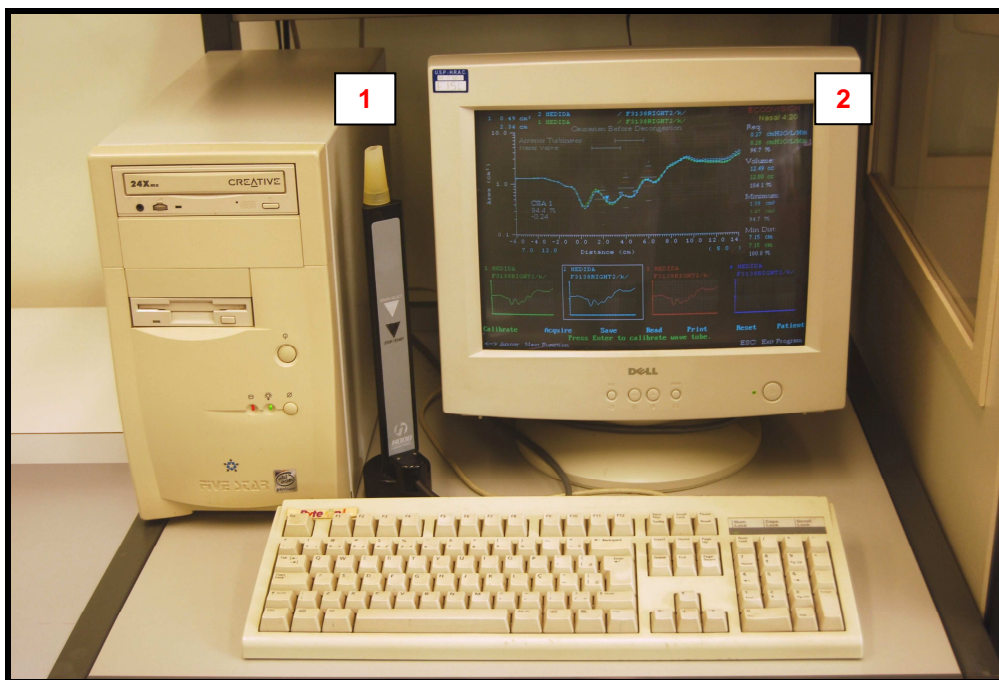
Figura 1 - Rinômetro Acústico: (1) tubo do rinômetro com adaptador nasal ( nosepiece ); (2) tela do microcomputador com rinograma.
