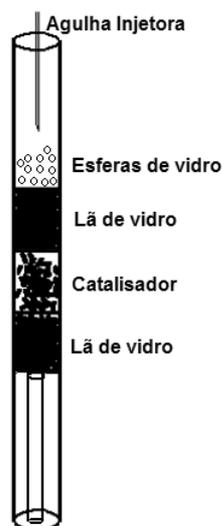
**Figura 4.2:** Representação esquemática da montagem do leito catalítico.
